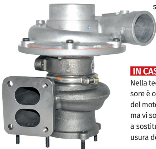
**L**a maggior parte dei motori diesel moderni è equipaggiata con un turbocompressore, così da poter aumentare le prestazioni in termini sia di potenza sia di coppia motrice, nonché di ridurre le emissioni e i consumi specifici.
